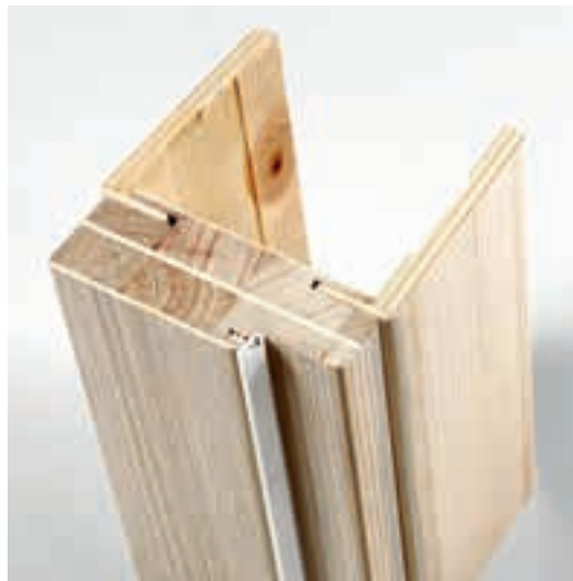
Telaio in listellare e coprifilo multistrato da 9 cm con aletta telescopica da 3 cm Frame in blockboard and 9 cm multilayer covermould with 3 cm telescopic wind
